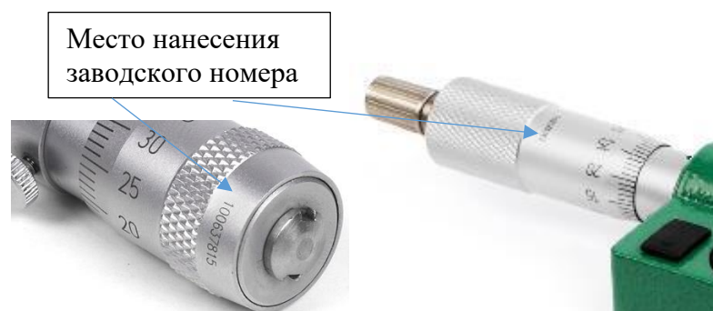
Рисунок 7 – Обозначение места нанесения заводского номера
